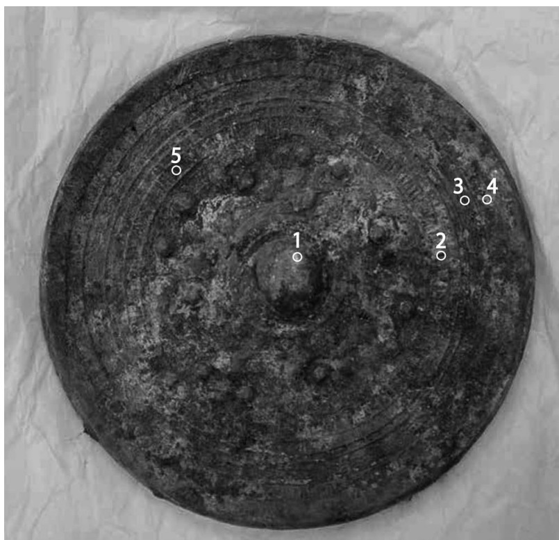
Fig.44 牛久石奈坂 1 号墳出土銅鏡の蛍光X線分析ポイント
