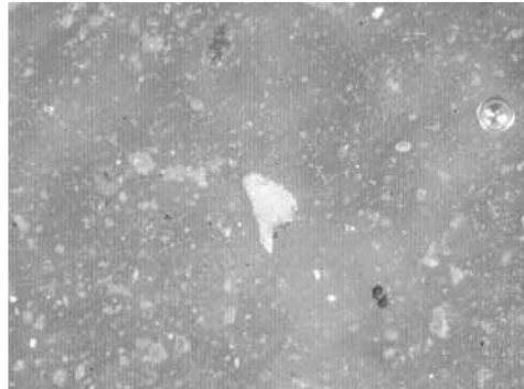
図版 2 第1層中部の偏光顕微鏡写真など 図版 2-1 第1層中部 40倍反射光像 中心の白色軽石が380 \mu 。
