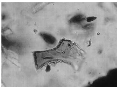
図版3-13 第3層上部。のっぺりした黄橙色スコリアガラス。長径 60\mu 、orrSHf \theta ・o型。
