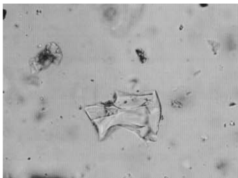
図版 3-4 第3層上部中の透明ガラス。長径40 \mu 。pPHf 0型。
